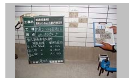
10 タイル接着力試験、タイル打音検査等の確認検査を実施します。
